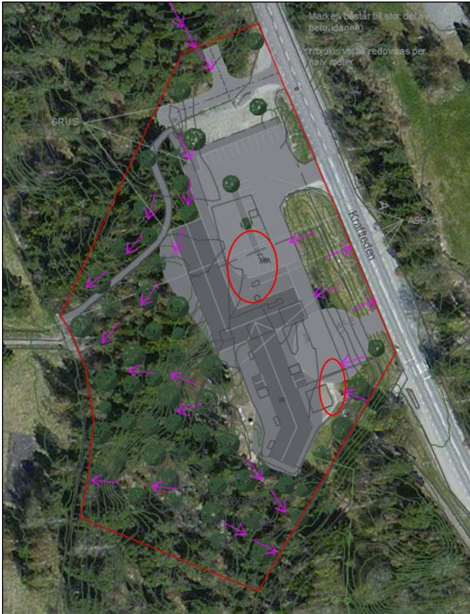
Figur 9. Områden med risk för stående vatten (inringat i rött)
