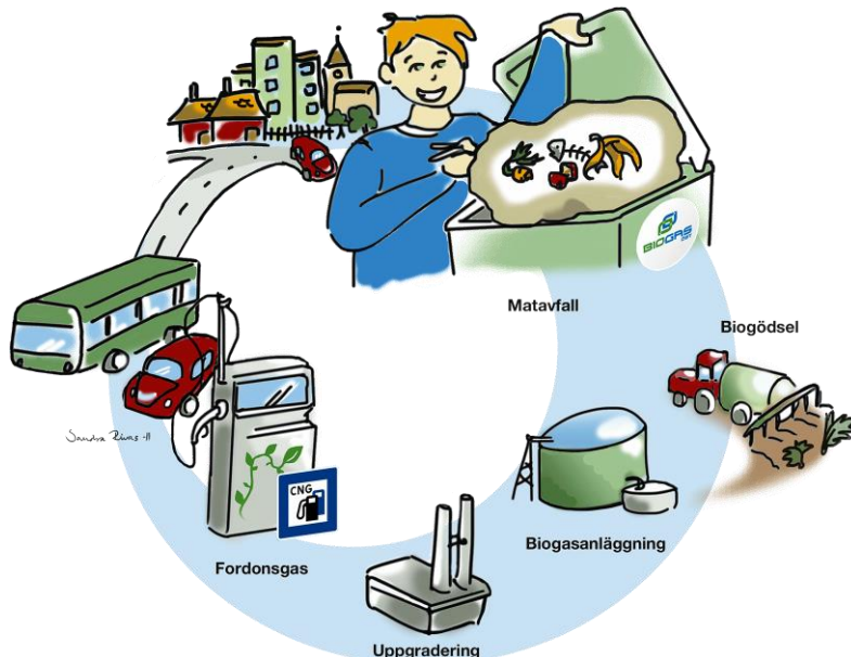
Figur 2. Flödesbild över matavfallsbehandling. Källa: Biogas Öst
